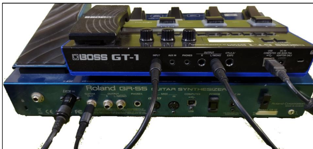
Figura 21 - Ligação física entre pedaleira e sintetizador, com excessão das fontes de energia
