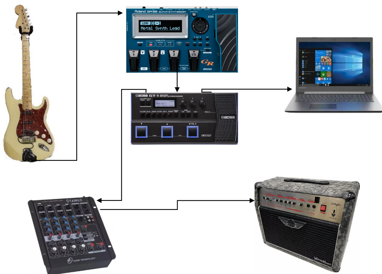
Figura 20 - Diagrama em bloco das conexões
