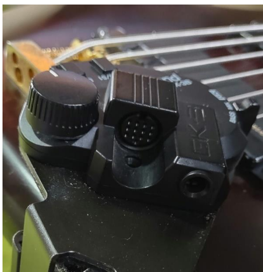
Figura 5 – Visão do jack 13PIN do GK-3B
